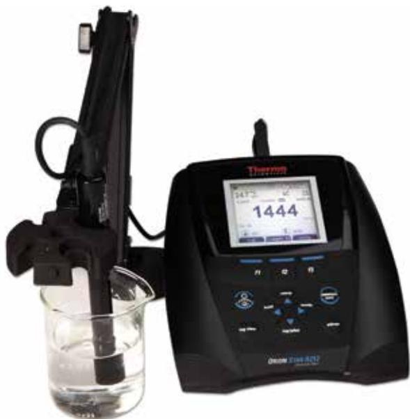
El Medidor de Mesa para Conductividad Orion Star A212 es la elección ideal para ayudar a cumplir los requisitos USP usando el kit de medidor para agua ultrapura medición de los niveles de conductividad estándar usando el kit para agua natural.
