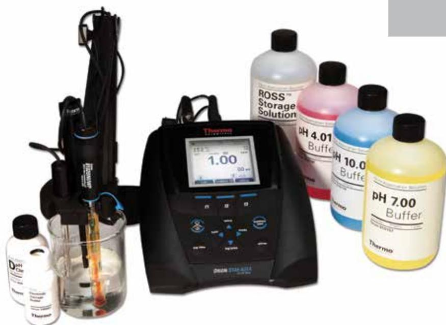
El electrodo de proceso ROSS puede ser usado en el medidor de lab Star A214 con la cubierta de tornillo 91CBNC a cable adaptador BNC. **Para información del electrodo 2001SC ROSS – [CLICK AQUÍ](#)**
